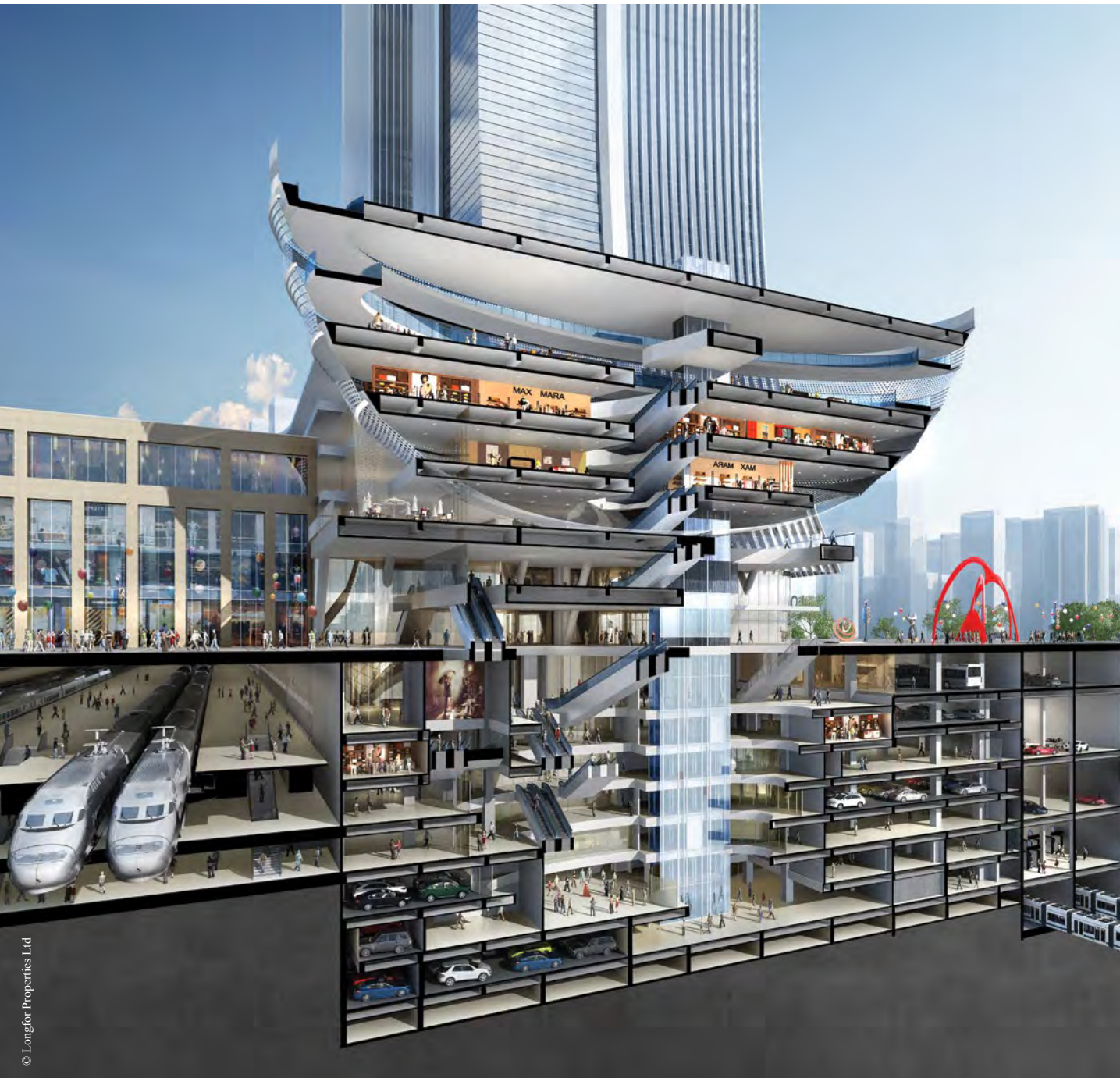
位于大楼中央的电梯/升降机系统贯穿地下地上所有楼层。
